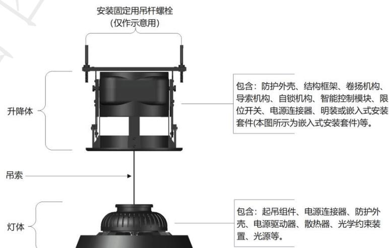
图 2 升降灯具的结构示意图
